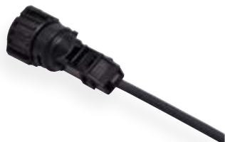
Konfektioniertes Kabel Typ FL33X33X 3 x 0,75 mm 2 mit 4-poligem Bajonettstecker ISO 15170 gerade
