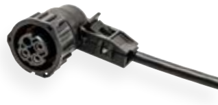
Konfektioniertes Kabel Typ CL105 3 x 0,75 mm 2 mit 4-poligen Bajonettstecker ISO 15170 Winkel 90°
